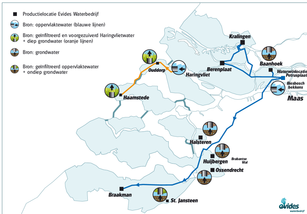
FIGUUR 6.3 DRINKWATERVOORZIENING EVIDES. ALLEEN DE PRODUCTIELOCATIES BERENPLAAT EN KRALINGEN LEVEREN AAN HET FOCUSGEBIED.
