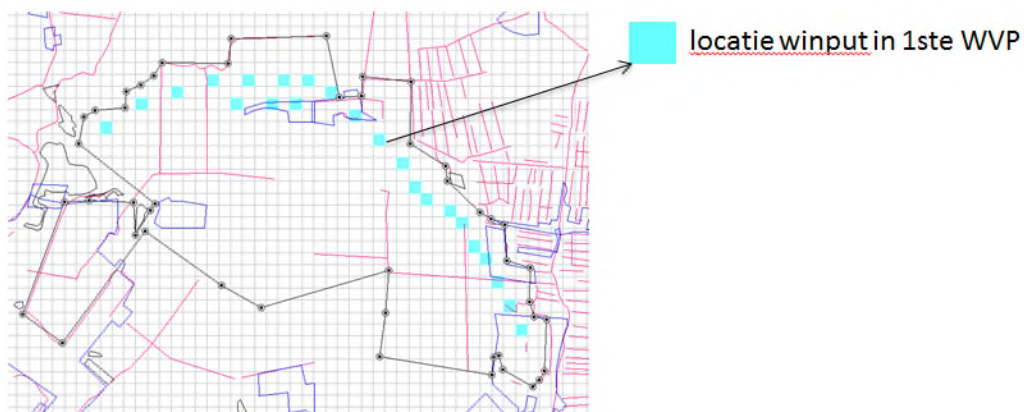
FIGUUR 4-12. DE LOCATIES VAN DE 23 WINPUTTEN IN HET EERSTE WATERVOEREND PAKKET IN HET NOORDELIJK DEEL VAN DE POLDER DE NOORDPLAS.
