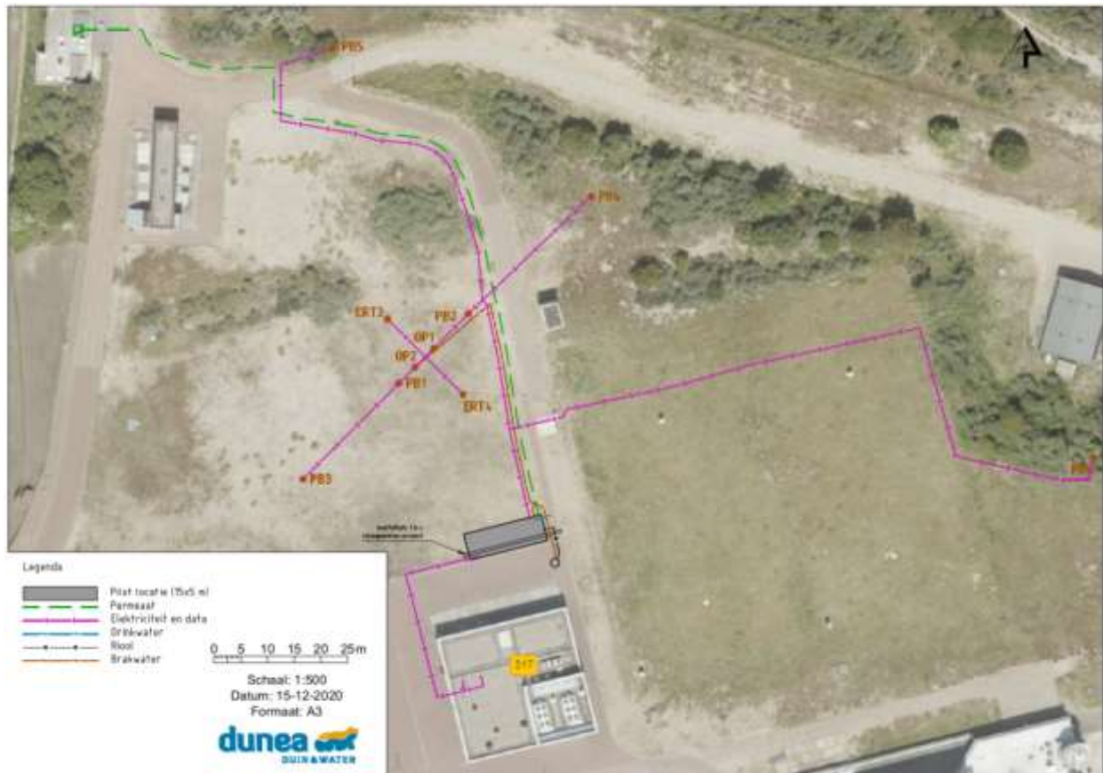
Figuur 6-1: Overzicht van infrastructuur die de connectie vormt tussen het puttenveld en de loods (pilot locatie) waarin meet- en zuiveringsactiviteiten plaats gaan vinden tijdens de pilot.
